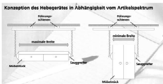
Aufbau der Vakuumhebetechnik.
